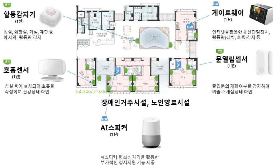
<그림11> IoT 센서 및 통신단말장치 설치(예시)
